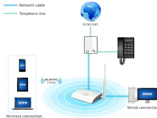
*Le modem routeur wifi ADSL2+, réf. 42211, intègre un modem ADSL2+ haute vitesse, un routeur NAT, un Wifi N Access Point et 4 ports LAN.*
